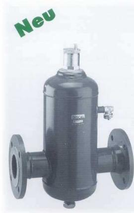
Mikroblasenabscheider, zum Abscheiden von Luft aus dem Anlagenwasser. Gehäuse aus lackiertem Stahl, Gittereinsatz aus Edelstahl.
