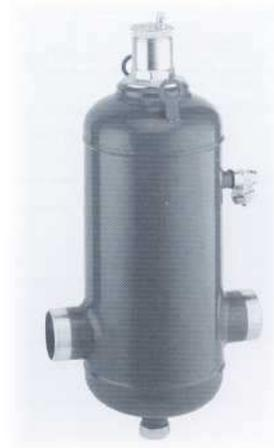
Mikroblasenabscheider, zum Abscheiden von Luft aus dem Anlagenwasser. Gehäuse aus lackiertem Stahl, Gittereinsatz aus Edelstahl.
