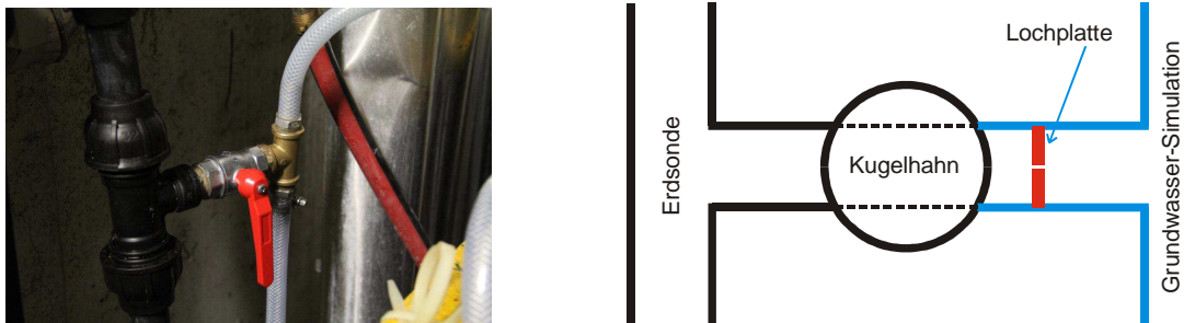
Abb.4 Ein Kugelhahn mit Lochplatte zur Simulation einer Leckage
