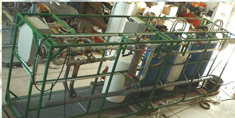
Wasserenthärtung für eine Catering einer Fluggesellschaft als Duplex-Anlage mit UV-Sterilisation (DVGW-geprüft) für höchste Ansprüche + Rückspülfilter, Leistung: 10m<sup>3</sup>/h, in zwei Stahlrahmen zum sicheren Transport.
