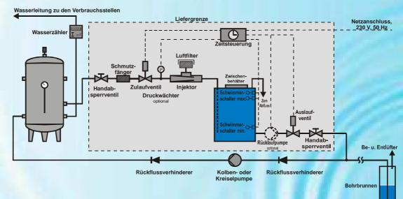
Diese Abbildung zeigt eine kleinere *AquaBonita*®-SITU-Anlage mit einer Zeitsteuerung für eine einfache Rammspitze oder einen Bohrbrunnen, wobei das mit Sauerstoff angereicherte Wasser über die Saugleitung zurückgeführt wird. Diese kleineren *AquaBonita*®-SITU-Anlagen füllen und entleeren den Behälter über eine Zeitsteuerung. Beim Füllen wird das zulaufende Wasser mit Sauerstoff gesättigt. Während des Füllens kann, zur Optimierung der Betriebsicherheit, der Druck überwacht werden.
