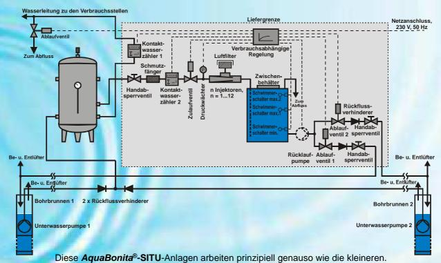
Um eine ausreichende Menge mit Sauerstoff gesättigtem Wasser in den Aquifer einzuleiten, arbeitet diese *AquaBonita®-SITU-*Anlage mit zwei Bohrbrunnen. Während der eine Bohrbrunnen als Förderbrunnen dient, wird der andere mit Sauerstoff angereichertem Wasser infiltriert. Bei der hier dargestellten *AquaBonita®-SITU-*Anlage erfolgt die Anreicherung mit Sauerstoff mit einer Regelung in Abhängigkeit vom Verbrauch.
