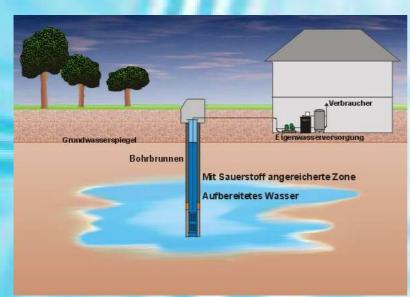
Bei dieser Wasseraufbereitung wird der Aquifer über den Förderbrunnen mit Sauerstoff angereichert. Dazu wird eine Teilwassermenge des geförderten Wassers über eine AquaBonita®-SITU-Anlage mit Sauerstoff nahezu gesättigt und dann über denselben Weg wieder in den Aquifer eingeleitet.
